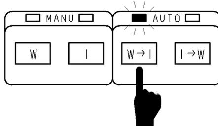
(2) **I→W**キーを押すと絶縁抵抗→耐電圧モードになり、キー上のランプが点灯します。
