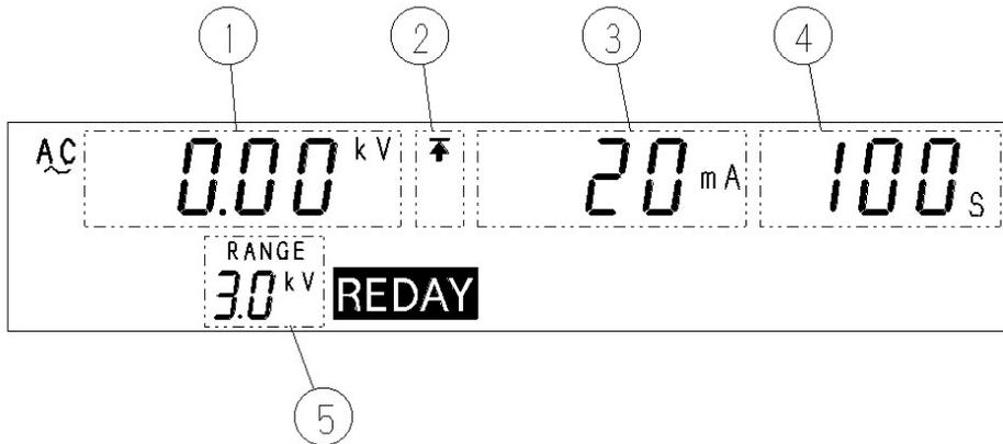
■ 蛍光表示管（耐電圧試験モード）
