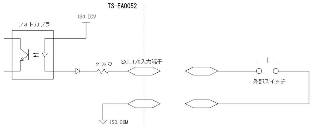
**注記** 入力信号との接続は、リレーやスイッチのチャタリングを防止する回路をつけ、誤動作しないように設定して下さい。
