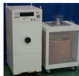
耐電圧試験器(写真上)や 高圧計器用変圧器(写真右) などの校正ができます。
