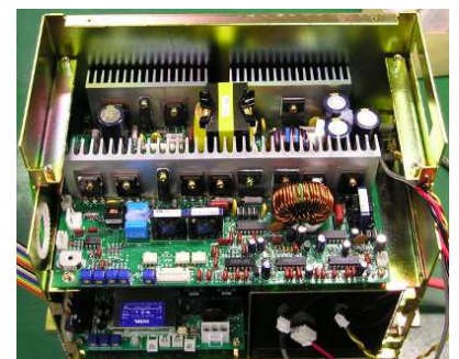
15kV 直流高電圧電源 内部写真
